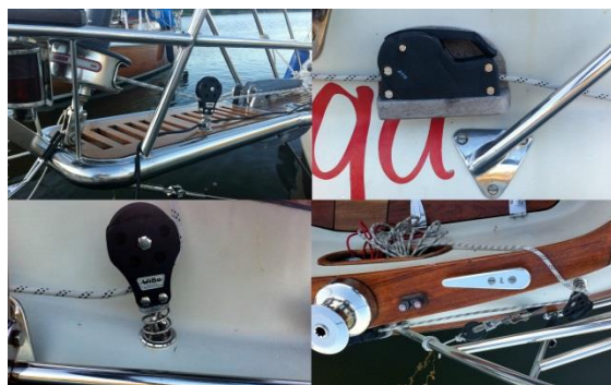
Beslag som underlättar hanteringen av rullgenuan (Fortsättning följer i nästa nummer)
