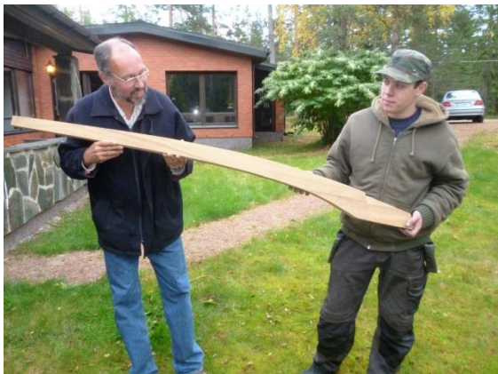
Ämnet till den nya rorkulten är ihoplimmad och tar form. Eken, som utgör det mellersta lagret, är tagen ur restvirket för Casella II:s bogspröt!
