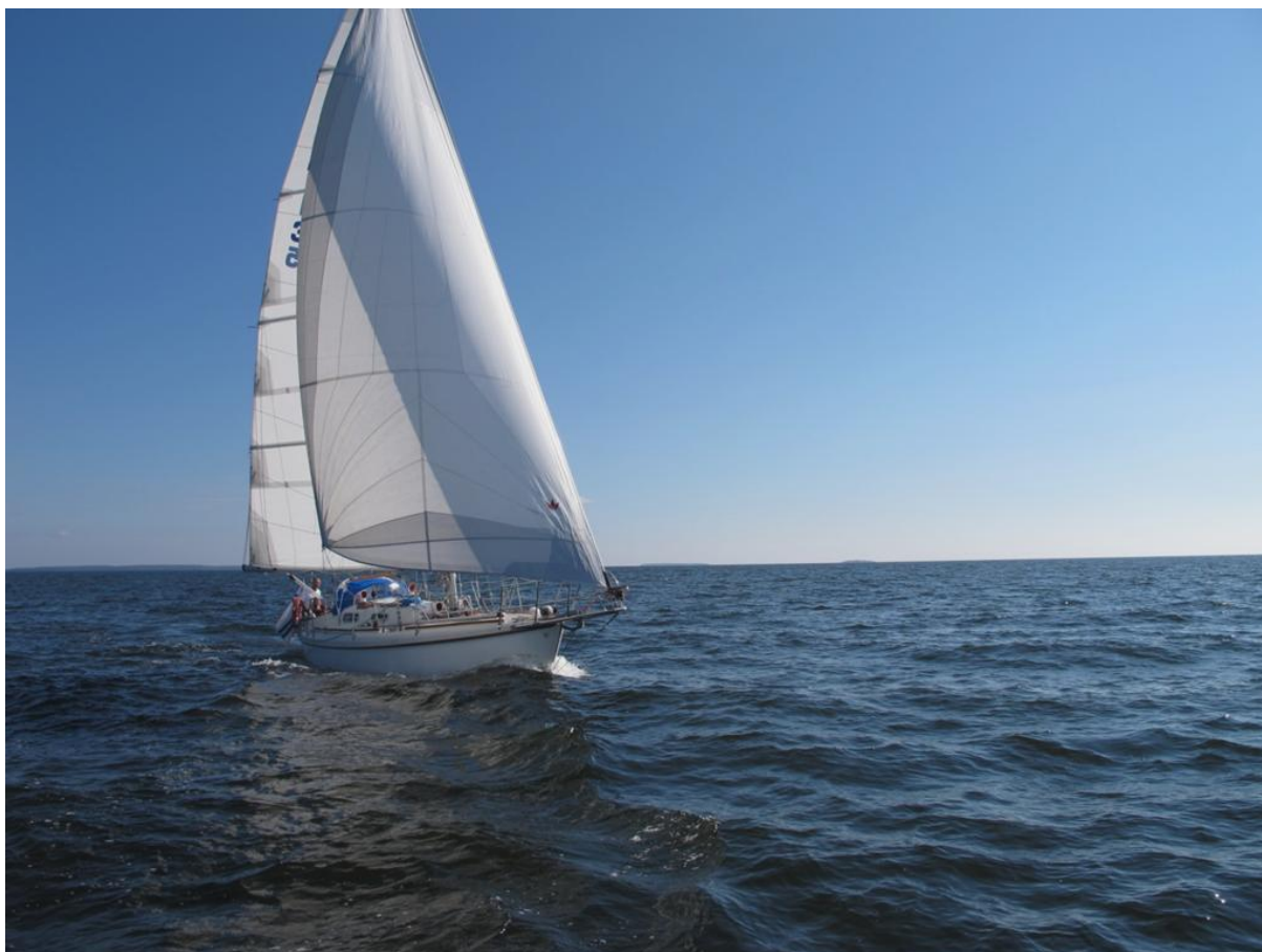
Svinga hinner upp en Swan 36. På bilden framträder Swanens häckvåg tydligt i mitten nedtill på bilden. L32:an "seglar utan häckvåg"! På bilden framträder den extra triangeln som syns in efter att riggen höjts och peket förlängts. Genuan blev lättare att skota och rulla in efter ändringen.
