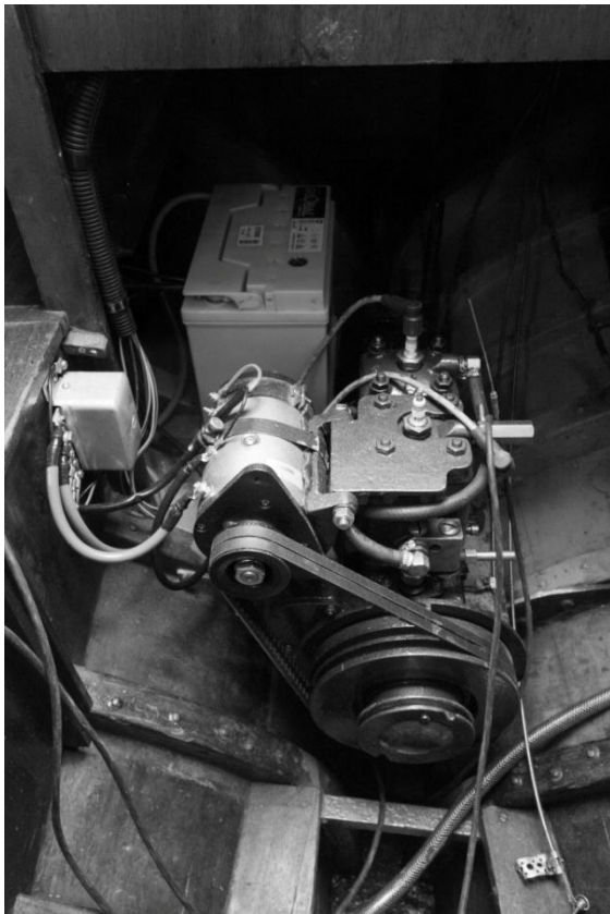
Den gamla Färe-Göta-motorn från sextioalet. Förgasaren är bortskruvad som första förberedelse för att lyfta ur den.
