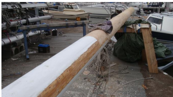
Trämastens nedre del renskrapad (vänster bild) och sedan efter epoxibehandlingen (höger bild)
