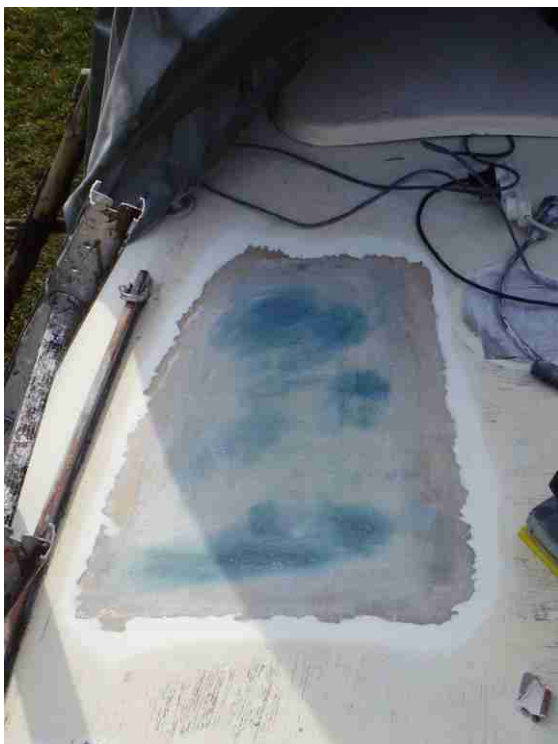
Delamineringen i däcklagad. Nästa steg är topcoat och målning.
