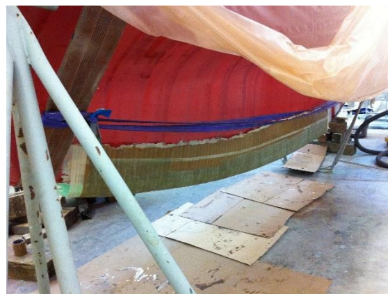
Den påbyggda ballasten undertill sedd förifrån. Avrundningen framtill ännu ogjord på bild.
