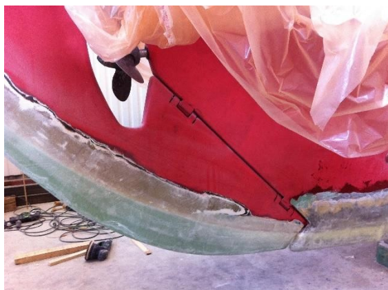
Förstörningen av roderbladet. Nu biter rodret med endast små utslag, men med rorkult av ursprunglig längd gissar jag att det vore för tungt att hålla.
